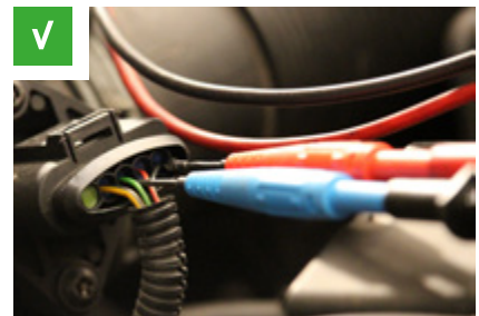
Рис. 3: Измерительный адаптер на тыльной стороне разъёма
